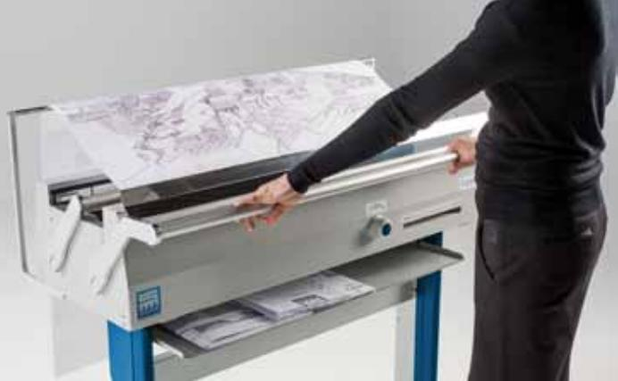
Avec FLEXFOLD 1.1 plier tes projets sera simple et rapide ! Ca suffit de débloquer la machine à travers le bouton dédié et ouvrir les bandes de pression, insérer la feuille et employer la tringle pour plier parfaitement à 21 cm.
